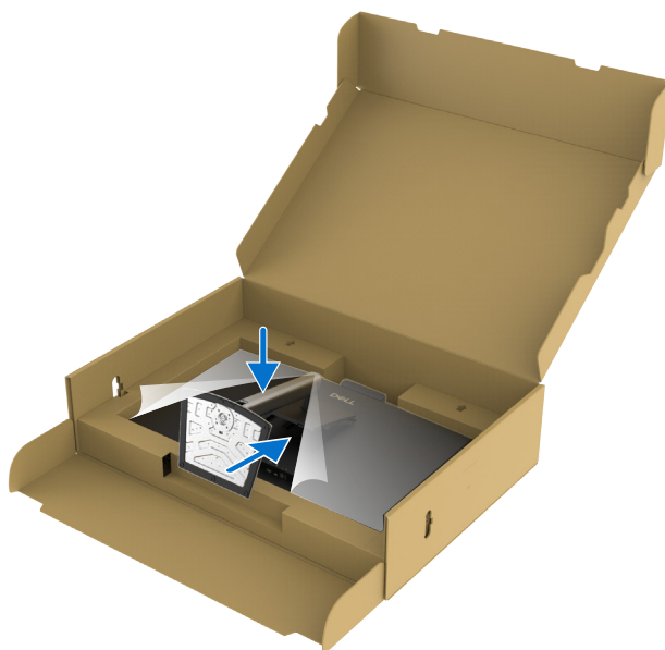
Rysunek 17. Wsuwanie wypustek na kolumnie podstawy w szczeliny
