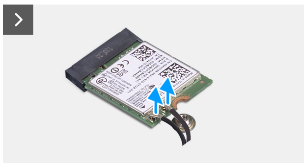
Ilustración 27. Extracción de la tarjeta inalámbrica
