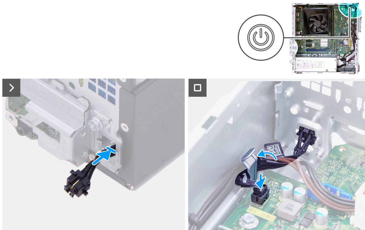
Ilustración 44. Instalación del botón de encendido
