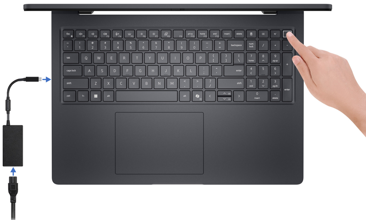
Afbeelding 8. Sluit de netadapter aan en druk op de aan-uitknop.
