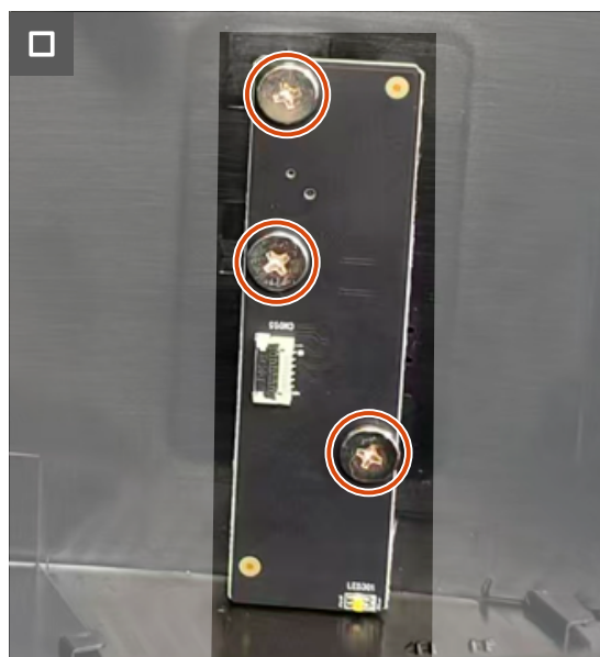
Rysunek 19. Zdejmowanie płyty klawiatury
