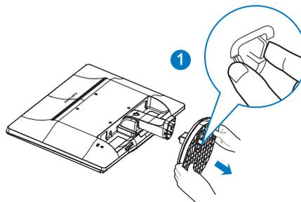
3. Appuyez sur le bouton de détachement pour détacher la colonne de base.
