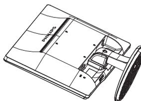
2. Appuyez sur les clips de verrouillage pour détacher le support de la colonne du socle.
