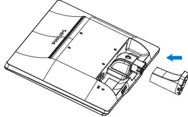
3. Tenez le support du socle du moniteur avec deux mains et insérez fermement le support du socle dans la colonne du socle.
