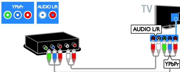
Schließen Sie den Player über ein Composite-Kabel (CVBS) und ein Audio L/R-Kabel am Fernseher an.
