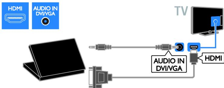
Schließen Sie den Computer über ein VGA-Kabel und ein Audiokabel am Fernseher an.
