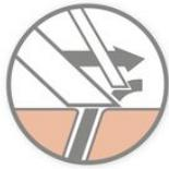
El sistema de doble cuchilla integrado de la afeitadora eléctrica de Philips levanta el pelo para cortarlo por debajo del nivel de la piel para un afeitado más apurado.
