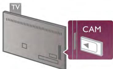
Utilize a ranhura da Interface Comum no lado esquerdo do televisor para introduzir o cartão CAM\*. Introduza totalmente o CAM com cuidado e deixe-o permanentemente na ranhura. A activação do CAM pode demorar alguns minutos. A remoção do CAM irá desactivar o serviço de emissão no televisor.
