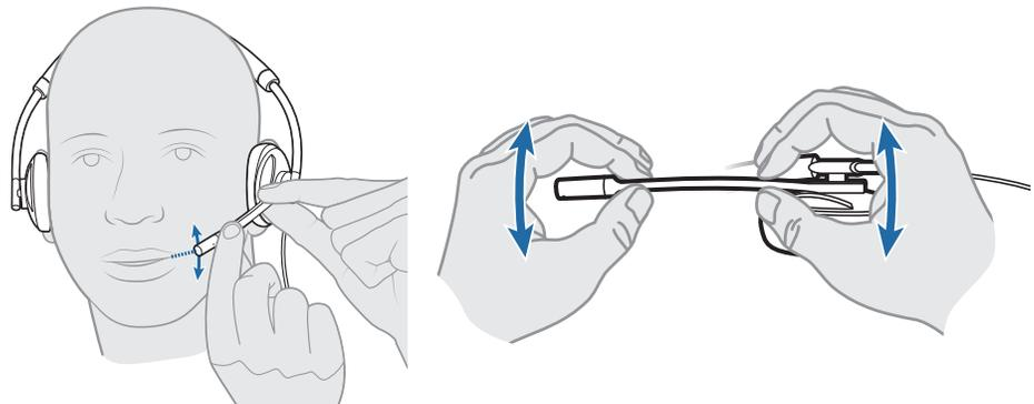
**HINWEIS:** Das Headset ist so konstruiert, dass der Mikrofonarm auf der linken Seite des Gesichts getragen wird. Um das Headset so zu tragen, dass sich der Mikrofonarm an der rechten Seite befindet, drehen Sie den Mikrofonarm nach oben, bis er an Ihrem rechten Mundwinkel ausgerichtet ist. Der linke und der rechte Audiokanal werden vertauscht.
