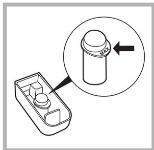
Funkcja ta przydatna jest w celu usuwania bardziej opornych plam. Wstawić dodatkowy pojemniczek 4, na wyposażeniu, do przegrodki 1. Przy dozowaniu wybielacza nie przekroczyć poziomu „max” wskazanego na
