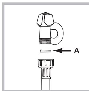
1. A vízbevezető cső csatlakoztatásához csavarozza fel a csövet egy 3/4"-os külső menettel rendelkező hidegvíz csapra (lásd ábra).
