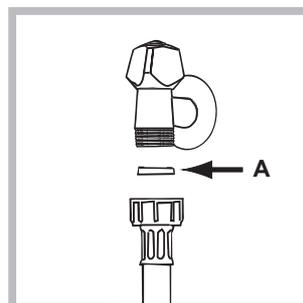
1. Wsunąć uszczelkę A do końcówki rury pobierania wody i przykręcić ją do kurka zimnej wody o gwintowanym otworze 3/4" (zobacz rysunek). Przed podłączeniem spuszczać wodę do momentu, aż stanie się ona całkowicie przezroczysta.
