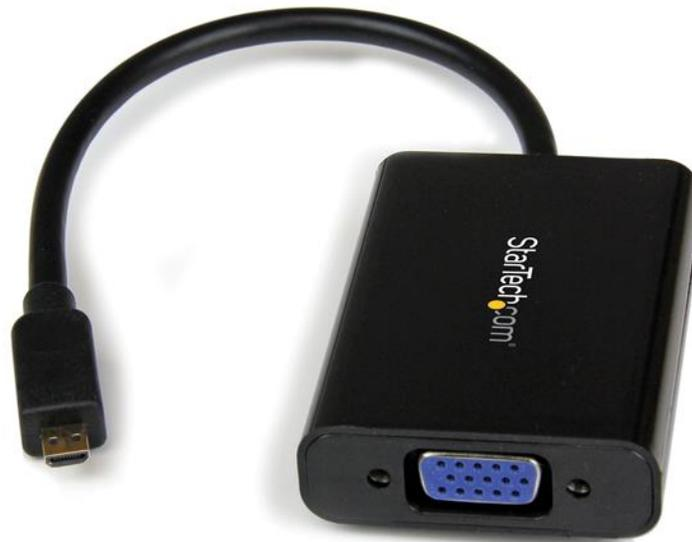
Mit dem Micro HDMI®-auf-VGA-Videoadapter MCHD2VGAA können Sie ein Smartphone oder Tablet-PC anschließen, das bzw. der Inhalt über einen Micro HDMI-Anschluss auf ein VGA-fähiges Displaygerät (TV, Monitor, Projektor) ausgibt und auch diskrete 2-Kanal-Analog-Audioausgabe von der Micro HDMI®-Quelle bietet.
