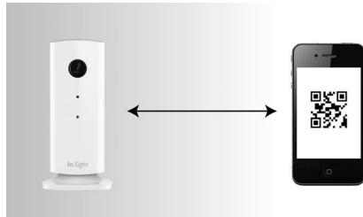
Die schnelle und einfache Installation ermöglicht Ihnen, die kabellose InSight Heimkamera mit einem Smartphone oder Tablet zu koppeln. Positionieren Sie das Bild des QR-Codes vor die Kameralinse, um die InSight App zu aktivieren. Die Kamera ist betriebsbereit, wenn das Licht dauerhaft grün leuchtet.
