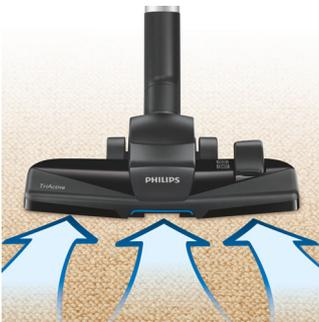
Die TriActive-Düse führt drei Reinigungsschritte in einem Arbeitsgang aus: 1) Sie raut mit der speziell entworfenen Unterseite den Teppich schonend auf, um tief liegenden Staub aufzunehmen. 2) Sie nimmt große Teile über ihre größere Öffnung an der Vorderseite auf. 3) Sie nimmt Staub und Schmutz längsseits von Möbeln und Wänden über ihre zwei Luftkanäle auf der rechten und linken Seite auf.
