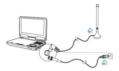
Connectez l'antenne à la prise d'antenne.
