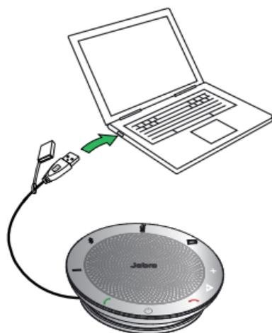
Collega il cavo USB di Jabra Speak 510 a qualsiasi porta USB disponibile sul PC per ricaricare la batteria. La spia della batteria è rossa quando il dispositivo è in ricarica e verde per un minuto quando è completamente carico.
