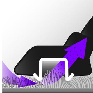
AeroSeal 吸嘴每次可捕获更多灰尘和绒毛, 这得益于其特别设计的底板。它可轻轻地打开地毯, 清除深处的灰尘。多亏了其出色的密封性能, 灰尘直接通过最大气流进入旋风中。
