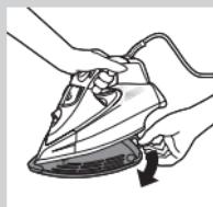
**1** Apenas em modelos específicos: retire a capa de protecção resistente ao calor.
