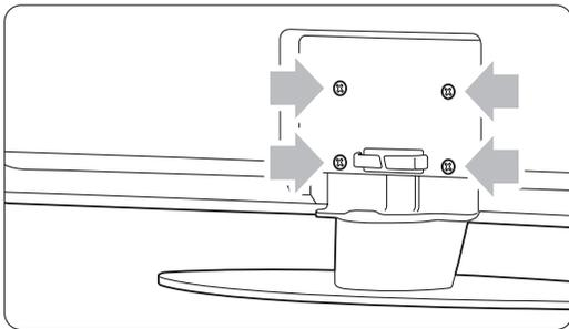
**2** Entfernen Sie die Schrauben.
