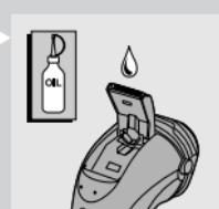
نکته: برای کسب بهترین عملکرد خط زن، هر شش ماه یکبار، دندانه خط زن را با یک قطره روغن چرخ خیاطی روغن کاری کنید.
