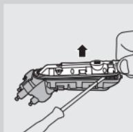
**8** Retirez le couvercle du bloc d'alimentation à l'aide d'un tournevis.
