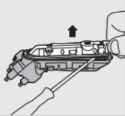
**8** Retire a cobertura da unidade de alimentação com uma chave de parafusos.
