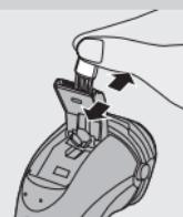
**2** Deslice el botón del cortapatillas hacia abajo para abrirlo.
