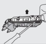
**8** Quite la cubierta de la unidad motora con un destornillador.
