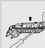
**8** Rimuovete il coperchio del gruppo di alimentazione con un giravite.
