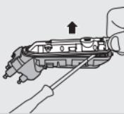
**8** Verwijder de bovenzijde van de aandrijfunit met een schroevendraaier.
