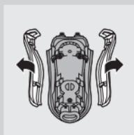
**5** Verwijder de twee zijpanelen.
