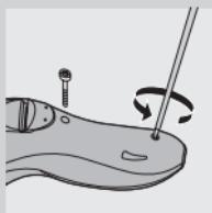
Verwijder de accu alleen wanneer u het scheerapparaat afdankt. Zorg ervoor dat de accu helemaal leeg is wanneer u deze verwijdert.
