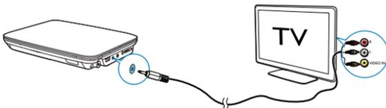
Achten Sie beim Anschließen darauf, dass die Farben der AV-Kabel denen der Buchsen entsprechen:
