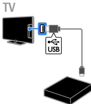
4. Ligue a TV e o disco rígido USB, se ele tiver uma fonte de alimentação externa.
