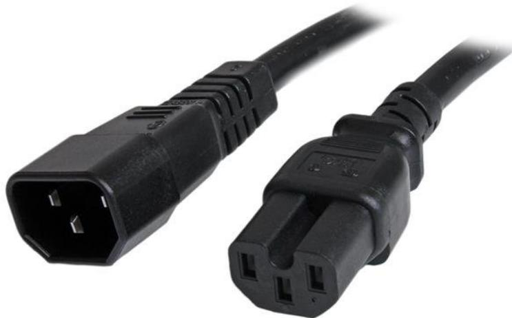
El cable de alimentación (1.8 m) C14 a C15 modelo PXTC14C156 incluye un conector C15 apropiado para equipos con funcionamiento a alta temperatura, así como alambre de 2.5 mm<sup>2</sup> apropiado para conexiones de alta potencia: una solución confiable para la conexión con unidades de alimentación (PDU) C14 situadas en entornos con conmutadores de alta tensión y centros de datos, o bien para aplicaciones de servidores grandes que requieren cableado de gran grosor.
