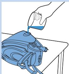
**2** Γείρετε τη γεννήτρια ατμού και ρίξτε στο στόμιο 500 ml αποσταγμένο νερό. Τοποθετήστε ξανά την τάπα EASY DE-CALC και γυρίστε τη δεξιόστροφα για να τη στερεώσετε.
