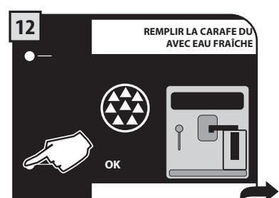
Vider complètement la carafe (page 42 - fig. 7) et la remplir d'eau fraîche potable. Introduire la carafe et la positionner en position de distribution. Appuyer ensuite sur la touche « OK ».
