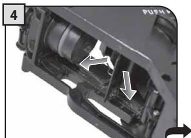
Distribuer la graisse de façon uniforme sur les deux convoyeurs latéraux.
