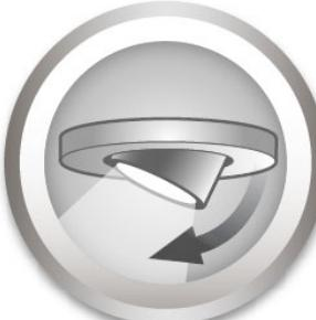
Чтобы направить свет в нужное место, держатель лампы можно регулировать, поворачивать и наклонять.
