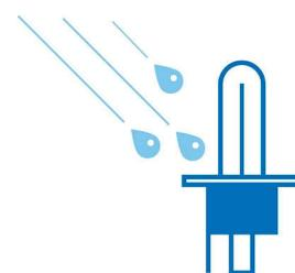
Лише лампа розжарювання, виготовлена з кварцевого скла (нитка розжарювання 2650 °C, скло 800 °C), може витримувати різні температурні стрибки, наприклад, коли крапля холодної води потрапить на гарячу лампу, що може статися під час подолання водної перешкоди з несправним блоком передньої фари.
