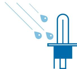
Nur eine leuchtende Glühlampe aus Quarzglas (Glühfaden 2.650 °C, Glas 800 °C) kann extremen Temperaturschwankungen widerstehen, wenn z. B. ein Tropfen kaltes Wasser auf die heiße Glühlampe fällt. Anwendung variiert je nach Glühbirnentyp.
