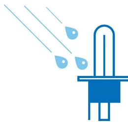
มีเพียงหลอดไฟที่ทำจากแก้วครอบซัลโฟิลส์ (ไส้หลอด 2650 °C และแก้ว 800 °C) ที่สามารถทนต่อการเปลี่ยนแปลงอุณหภูมิทันทีทันใจได้: เช่น ถ้าเมียดนา้เย็นตกรอบหลอดไฟที่กำลังร้อน ชื้นอาจเกิดขึ้นได้ เมื่อคุณขับผ่านน้ำแข็งและเมื่อไฟน้ำที่บารودอยู่ ^ การใช้งานแตกต่างกันไปตามประเภทหลอดไฟ
