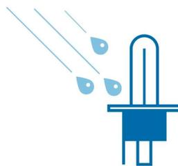
Nur eine brennende Glühlampe aus Quarzglas (Glühfaden 2.650 °C, Glas 800 °C) kann extremen Temperaturschwankungen widerstehen, wenn z. B. ein Tropfen kaltes Wasser auf die heiße Glühlampe fällt.
