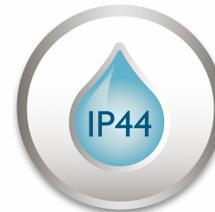
Die Schutzart IP44 bedeutet, dass das Produkt für den Gebrauch im Außenbereich entwickelt wurde. Somit können Sie sich sicher sein, dass die Außenleuchten Ihren Garten sowohl bei Regen als auch bei Sonnenschein oder Schnee problemlos beleuchten werden.
