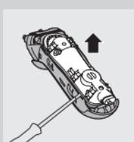
**6** Z izvijačem odstranite hrbtno ploščo napajalne enote.
