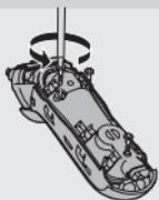
**5** Odkręć trzy śruby modułu zasilającego.
