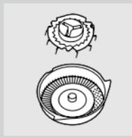
**1** Otevřete holicí jednotku, otočte pojistku směrem doleva (1) a vyjměte přídržný rámeček (2).
