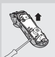
**6** Îndepărtați panoul posterior al unității de alimentare etanșe cu ajutorul unei șurubelnице.
