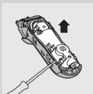
**6** Uklonite zadnju ploču zapečaćene jedinice za napajanje pomoću odvijača.
