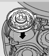
**4** Stare brivne glave odstranite iz brivne enote in jih nadomestite z novimi. Namestite nosilno ogrodje nazaj na brivno enoto in zavrtite zaklep proti desni.
