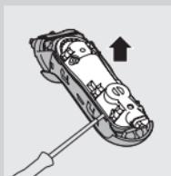
**6** Csavarhúzó segítségével vegye le a tömített motoregység hátsó elemét.
