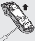
**6** С помощью отвертки снимите заднюю панель с герметичного блока питания.
