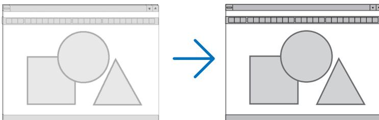
**PHASE** ..... Utiliser cet élément pour régler la phase de l'horloge ou pour réduire le bruit vidéo, les interférences ou la diaphonie. (C'est évident lorsqu'une partie de votre image semble miroiter.)
