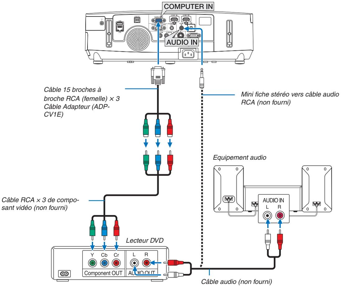
Un signal composant sera automatiquement affiché. Si ce n'est pas le cas, sélectionner dans le menu [CONFIG.] → [OPTIONS(1)] → [SELECTION DU SIGNAL] → [ORDINATEUR], puis cocher la touche Radio composant.
