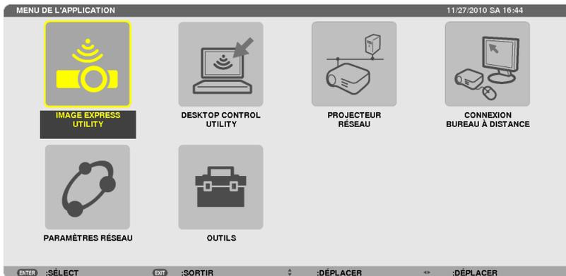
3. Dans le menu [MENU DE L'APPLICATION] utilisez le clavier sans fil pour sélectionner [CONNEXION BUREAU À DISTANCE].
