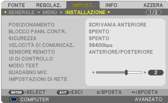
**Selezione dell'orientamento del proiettore [POSIZIONAMENTO]**
