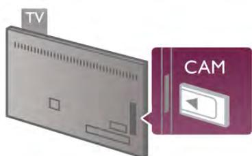
Utilizzare lo slot per interfaccia comune del televisore per inserire la scheda CAM\*. Inserire delicatamente il modulo CAM fino in fondo e lasciarlo sempre nello slot. L'attivazione del modulo CAM potrebbe richiedere alcuni minuti. Rimuovendo il modulo CAM si disattiva il servizio di trasmissione sul televisore.
