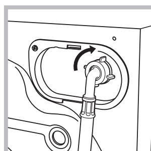
2. Pripojte prítokovú hadicu k práčke, jej zaskrutkováním k príslušnej prípojke na vodu, umiestnejnej vpravo hore (viď obrázok).
