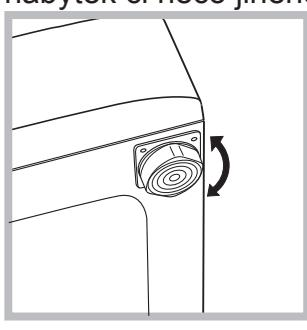
2. V případě, že podlaha není dokonale vodorovná, mohou být případné rozdíly vykompenzovány šroubováním předních nožek (viz obrázek); Úhel sklonu, naměřený na pracovní ploše, nesmí přesáhnout 2°.
