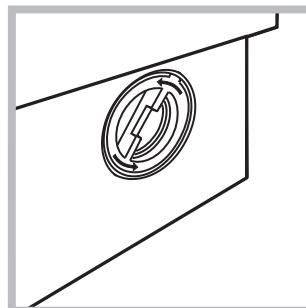
2. odšroubuje výko jeho otáčením proti směru hodinových ručiček (viz obrázek): vytěčení malého množství vody je zcela běžným jevem;
