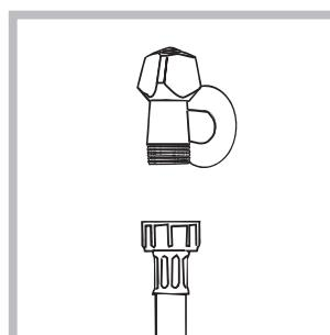
1. Підключіти трубу подачі, прикрутивши її до крану холодної води за допомогою штуцера з газовою різьбою 3/4(див. схему). Перед підключенням зливайте воду, доки вона не стане прозорою.
