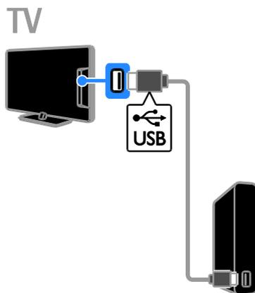
Collegare al televisore un disco rigido tramite un cavo USB.
