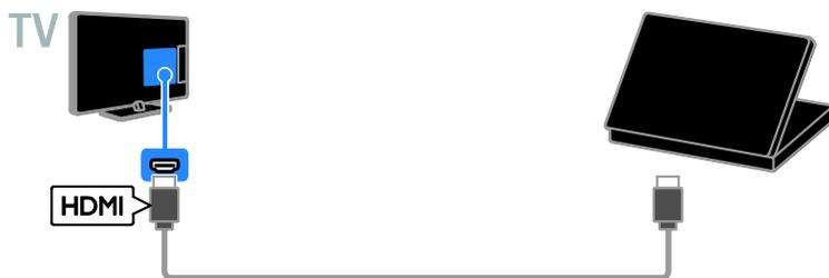
Collegare al televisore il computer tramite un cavo DVI-HDMI e un cavo audio.
