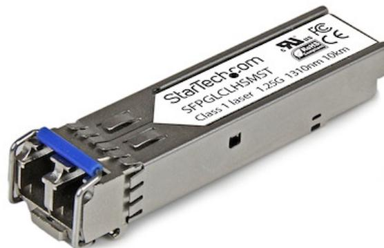
El modelo SFPGLCLHSMST es un módulo transceptor por fibra óptica compatible con Cisco GLC-LH-SM, diseñado, programado y probado para su funcionamiento con enrutadores y conmutadores de la marca Cisco®. Ofrece conectividad fiable a 1GbE (1000Mbps) a través de cableado de fibra, para redes compatibles con 1000BASE-LX/LH, a una distancia máxima de hasta 10km.
