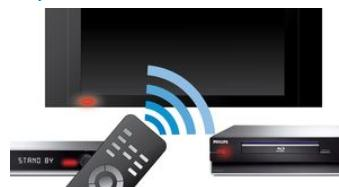
EasyLink 让您可以通过一个遥控器控制 DVD 播放机、蓝光光盘播放机、平板影院扬声器、家庭影院和电视等多台设备。它使用 HDMI CEC 行业标准协议，并通过 HDMI 连接线在设备之间共享功能。只需轻触按钮，您就可以同时操控支持 HDMI CEC 的所有连接设备。待机和播放等功能尽在您的掌握之中。
