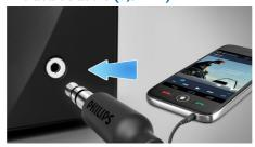
Con solo una sencilla conexión podés disfrutar de toda tu música en dispositivos portátiles y computadoras. Solo conectá tu dispositivo en el puerto de ENTRADA DE AUDIO (3,5 mm) en tu equipo Philips. En las computadoras, la conexión se realiza generalmente en la entrada de audifonos. Una vez conectado podrás disfrutar de toda tu colección musical, directamente en un conjunto superior de parlantes. Philips simplemente entrega el mejor sonido
