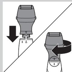
**1** Установите на прибор узкую бритвенную головку (см. раздел “Установка и снятие насадок” в главе “Подготовка прибора к работе”).
