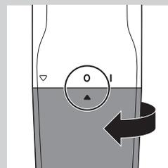
**7** Чтобы отключить прибор, установите крышку отсека для батареи в положение “выключено” (0).
