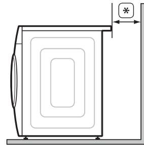
Se si installano insieme lavatrice e asciugatrice, nella parte anteriore del vano o dello scomparto deve essere presente un'apertura di ventilazione non ostruita di almeno 500 mm. Per la sola lavatrice non è necessaria un'apertura di ventilazione.
