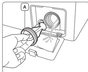
4. Pulire accuratamente il filtro detriti rimuovendo ogni residuo. Assicurarsi che l'elica della pompa di scarico dietro il filtro detriti non sia bloccata.
