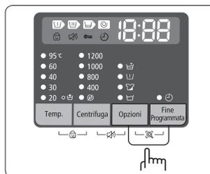
3. Eseguire l'applicazione **Samsung Smart Washer** sullo smartphone e toccare il tasto **Smart Check**.
