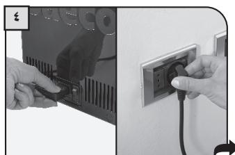
أدخل القابس داخل موضع المقبس خلف الجهاز وأدخل الطرف الآخر داخل مقبس الكهرباء بحيث يكون التيار الكهربائي مناسب.
