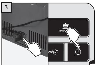
اضبط ووضع زر الكهرباء إلى الوضع "I". اضغط على زر الانتظار لبدء تشغيل الجهاز.
