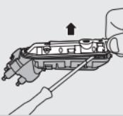
**7** Retirez le panneau arrière du bloc d'alimentation à l'aide d'un tournevis.
