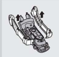
**3** Desaperte os quatro parafusos na parte da frente da máquina de barbear com a ajuda de uma chave hexagonal e retire o painel frontal do corpo da máquina.
