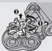
**4** Extraiga los cabezales de afeitado y coloque los nuevos en la unidad de afeitado. Coloque de nuevo el marco de retención en la unidad de afeitado y gire el cierre de seguridad en el sentido de las agujas del reloj.
