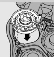
Assicuratevi che le sporgenze delle testine di rasatura si inseriscano perfettamente nelle rientranze.
