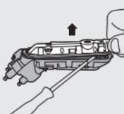
**7** Retire o painel traseiro da unidade de alimentação selada com a ajuda de uma chave de parafusos.
