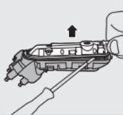
**7** Verwijder het achterpaneel van de waterdichte voedingsunit met een schroevendraaier.
