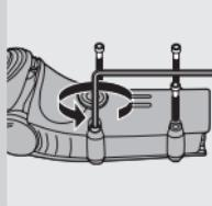
**2** Deixe a máquina de barbear a trabalhar até parar, desaperte os dois parafusos da câmara de recolha dos pelos com a ajuda de uma chave de parafusos e retire-a.
