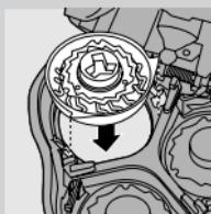
**2 Cihazla birlikte gelen fırça ile kesici ve koruyucu parçaları temizleyin.**
