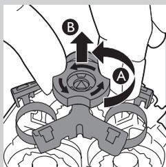
**4** Ruotate il sistema di bloccaggio in senso antiorario (A) e rimuovete la struttura di supporto (B).
