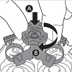
**7** Coloque de nuevo el marco de retención en la unidad de afeitado (A) y gire el cierre de seguridad en el sentido de las agujas del reloj (B).
