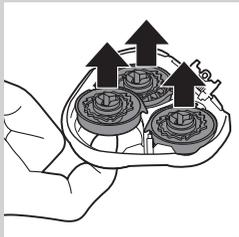
**5** Ta av og rengjør ett skjærehode av gangen. Hvert skjærehode består av en kniv og en lamelltopp.
