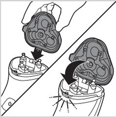
**8** Stecken Sie die Führung der Schereinheit in den Schlitz oben am Rasierer. Schließen Sie dann die Schereinheit.
