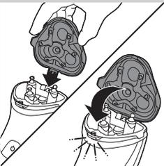
**8** Introduza a saliência do acessório de corte na ranhura na parte superior da máquina de barbear. Em seguida, feche o acessório de corte.
