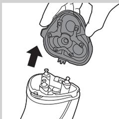
**3** Trekk skjæreenheten av barbermaskinen.
