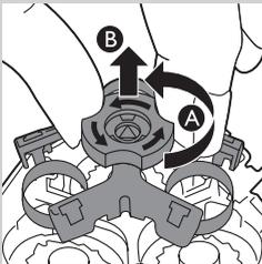
**4** Draai de vergrendelknop linksom (A) en verwijder de opsluitplaat (B).
