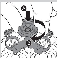
**6** Rimontate la struttura di supporto sull'unità di rasatura (A) e ruotate il pulsante di sgancio in senso orario (B).
