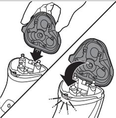
**8** Inserte el saliente de la unidad de afeitado en la ranura de la parte superior de la afeitadora. A continuación, cierre la unidad de afeitado.
