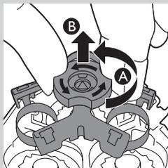
**4** Faites tourner le système de fixation dans le sens inverse des aiguilles d'une montre (A), puis retirez-le (B).
