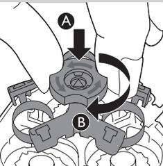
**7** Volte a colocar a armação de fixação no acessório de corte (A) e rode o bloqueio para a direita (B).
