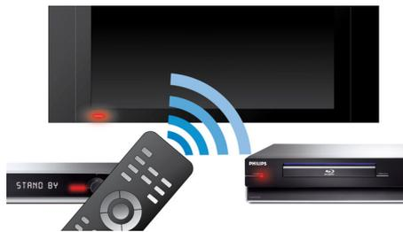
Com o EasyLink, você pode controlar vários dispositivos, como aparelhos de DVD, Blu-ray players, TVs etc., usando um único controle remoto. Ele utiliza o protocolo padrão da indústria HDMI CEC para compartilhar funcionalidades entre dispositivos usando o cabo HDMI. Com o toque de um botão, você pode operar simultaneamente todos os seus equipamentos compatíveis com HDMI CEC conectados. Agora, funções como o modo de
