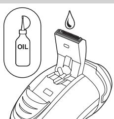
提示：为获得最佳修剪性能，请每隔六个月用一滴缝纫机油润滑修剪器齿。
