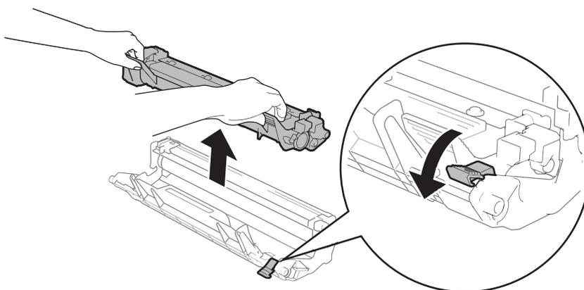
Drehen Sie das Zahnrad der Trommeleinheit mit der Hand und untersuchen Sie dabei die Oberfläche der Trommelrolle (1).
