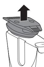
**3** Extraiga el cabezal de corte del aparato.
