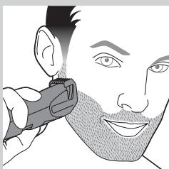
El aparato incluye dos peines-guía: uno estándar y otro de precisión. Estos peines-guía mantienen el cabezal de corte a una distancia determinada de la piel. La distancia determina la longitud del pelo restante y se puede ajustar girando la rueda de zoom.
