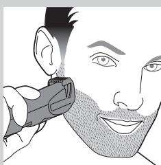
O aparelho é fornecido com dois pentes: um pente normal e um pente de precisão. Estes pentes mantêm a cabeça aparadora a uma determinada distância da sua pele. Esta distância determina o comprimento restante do pelo e pode ser ajustada rodando a roda para aumentar e diminuir o comprimento.
