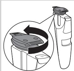
*Bemærk: Hvis du trimmer med laserstyret, skal du sørge for, at du skubber laserstyret til positionen "off", før du vender trimmerhovedet. Du kan beskadige laserstyret, hvis du forsøger at dreje trimmerhovedet, mens laserstyret stadig er oppe.*
