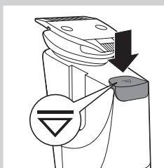
**2** Para recortar con la guía láser, presione la parte superior de la misma para encenderla.
