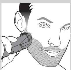
Het apparaat wordt geleverd met twee kammen: een normale kam en een precisiekam. Deze kammen houden het trimhoofd op een vaste afstand van uw huid. Deze afstand bepaalt de resterende haarlengte. U kunt deze afstand aanpassen door aan het instelwiel te draaien.
