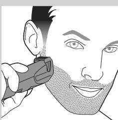
Das Gerät wird mit 2 Aufsätzen geliefert: einem Standardkammaufsatzz und einem Präzisionskammaufsatzz. Diese Aufsätze halten den Scherkopf in einem bestimmten Abstand von Ihrer Haut. Dieser Abstand bestimmt die verbleibende Haarlänge und kann durch Drehen des Zoom Wheels angepasst werden.
