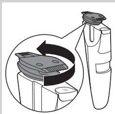
*Merk: Hvis du trimmer med laserguiden, må du passe på at du skyver laserguiden til av-stilling før du snur trimmehodet. Du kan skade laserguiden hvis du prøver å snu trimmehodet mens laserguiden fortsatt er øppen.*
