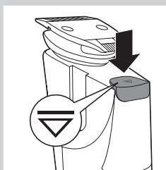
*Opmerking: Als u met de lasergeleider trimt, zet deze dan in de 'uit'-stand voordat u het trimhoofd draait. U kunt de lasergeleider beschadigen als u probeert het trimhoofd te draaien terwijl de lasergeleider nog omhoog staat.*
