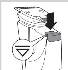
**2** For at trimme med laserstyr skal du trykke på toppen af laserstyret for at tænde det.
