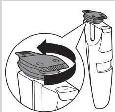
*Nota: Si recorta con la guía láser, asegúrese de ponerla en la posición de apagado antes de girar el cabezal de corte. Puede dañar la guía láser si intenta girar el cabezal de corte mientras esta sigue fuera.*
