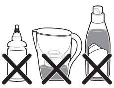
**Attention : N'utilisez pas d'eau parfumée, d'eau provenant d'un sèche-linge, d'eau de pluie, de vinaigre, d'eau minérale, d'eau magnétique (Aqua+), d'eau provenant d'un filtre à eau, d'amidon, de détartrants, de produits de repassage, de sel ou d'autres produits chimiques dans le réservoir d'eau. Ces liquides ont été testés. Ils ne sont pas adaptés à l'appareil et risquent même de l'endommager. Votre garantie s'annule si vous utilisez l'un de ces produits.**
