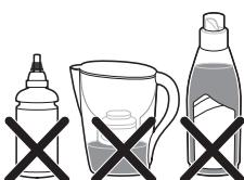
**Attenzione: Non riempite il serbatoio con profumi, acqua proveniente da asciugatrici, acqua piovana, aceto, acqua minerale, acqua trattata magneticamente (Aqua+), acqua proveniente da un filtro per acqua potabile, amido, agenti disincrostanti, prodotti per la stiratura, sale o prodotti chimici. Questi tipi di acqua sono stati testati, risultando non adatti per l'apparecchio e spesso causa di danni. Se utilizzate questi tipi di acqua, la garanzia decade.**
